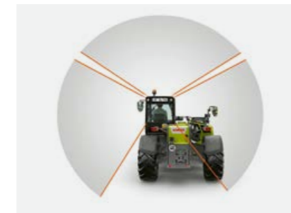
Esteetön, työturvallisuutta lisäävä näkyvyys myös taakse, teleskooppipuomin matalan asennuksen ansiosta.
