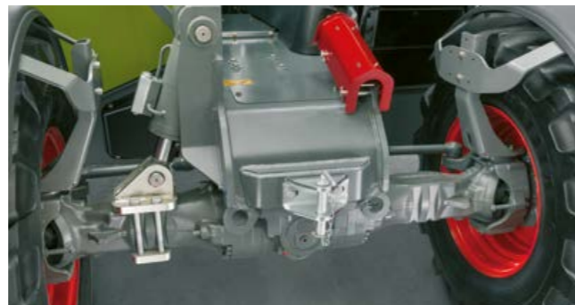
Lisäturvallisuutta maastossa, hydraulisen kallistuksen vakaajan ansiosta.
