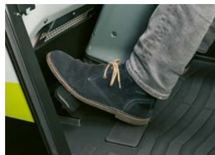
Hivutustoiminnolla varustettu jarrupoljin vähentää polttoaineen kulutusta ja jarrujen kulumista.
