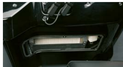
Helppo käsiksi pääsy ohjaamon raitisilmasuodattimeen.
