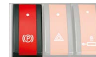
Tällä kytkimellä pysäköintijarru voidaan kytkeä käsikäytöllä päälle.
