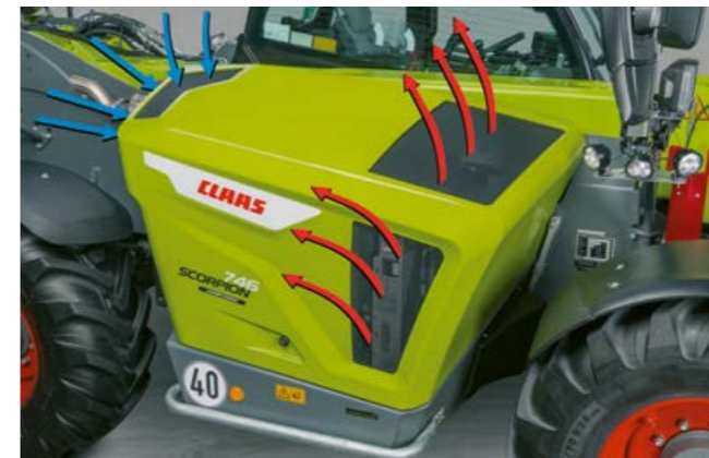
Kuljettaja voi käsikäytöllä milloin tahansa ottaa käyttöön puhaltimen suunnanvaihdon.
