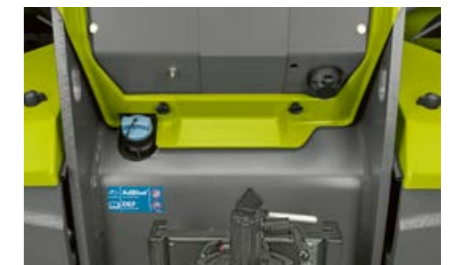
Hyvin käsillä oleva AdBlue täyttöaukko® tehostaa pakokaasujen jälkikäsitelyä.
