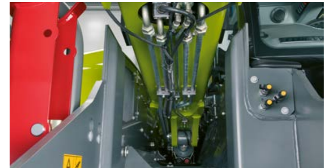
Kaikkiin yli 4.500 kg:n nostovoimalla olevissa kurottajissa on vakiona runkoon integroidut teleskooppipuomin sivuttaisohjurit.
