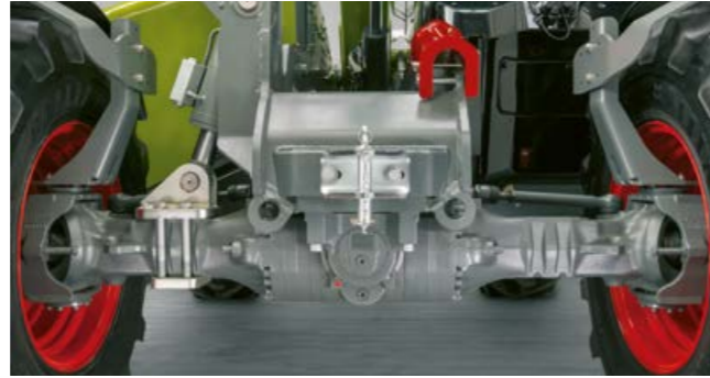
Alusta hydraulisella tasauksella.
