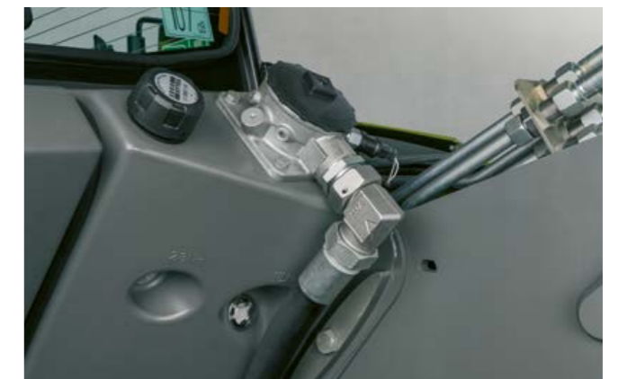
Hydrauliikkaöljyn määrä on helposti tarkistettavissa mittalasisista. Paluusuodatin suojaa hydrauliikkajärjestelmää. Suodattimen vaihtoväli on 1.000 käyttötuntia.
